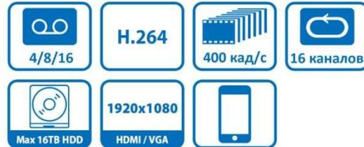
**DH-DVR1604LE-U:** 16 видеовходов, 16 аудиовходов, 16 сквозных каналов и 1 канал матричного выхода. Первый и девятый каналы видео поддерживают запись в реальном времени с разрешением D1(4CIF), остальные - CIF в реальном времени. Поддержка VGA, HDMI, eSATA, USB2.0 и 8 жестких дисков.
